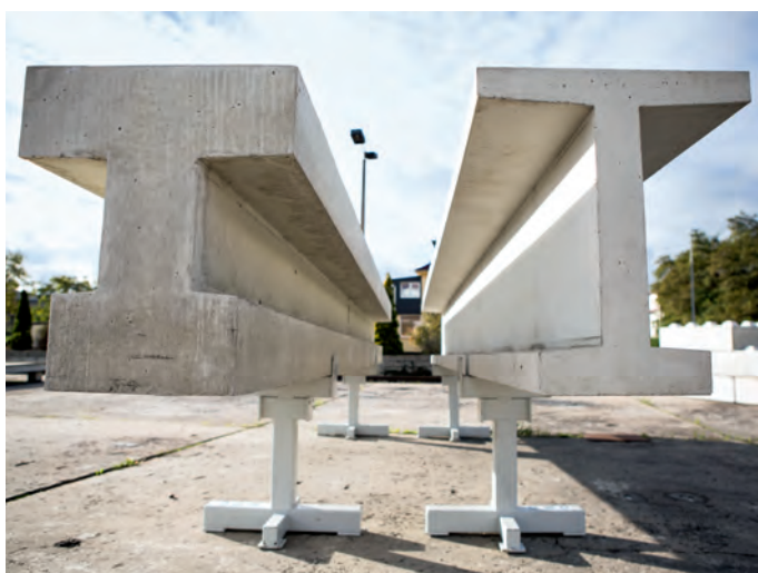
Abb. 1: Doppel-T-Träger – Stahl-/Carbonträger im Vergleich (Foto: Thilo Schoch)
