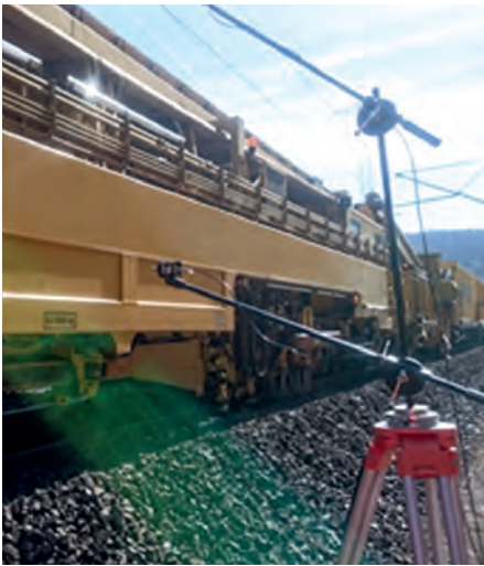
Abb. 3: Mikrofonposition bei der Vermessung einer GBM (gleisgebundene Großbaumaschine)
