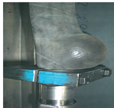
Abb. 2: Im Auftrag der BG BAU durchgeführter Druckversuch an einer Förderleitung bis zum Versagen durch Platzen
