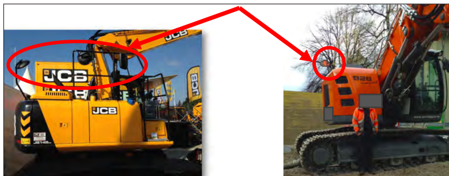
Abb. 4: Der Gefahrenbereich kann über den Spiegel rechts bzw. rechts hinten nicht eingesehen werden
