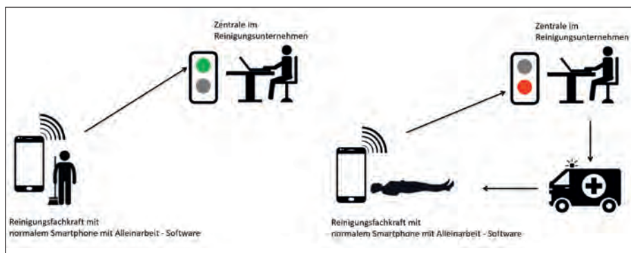
Abb. 6: Funktionsweise des Ampelsystems bei Verwendung eines Smartphones mit Software Alleinarbeitsschutz (Grafiken: Jacqueline Ruhl)
