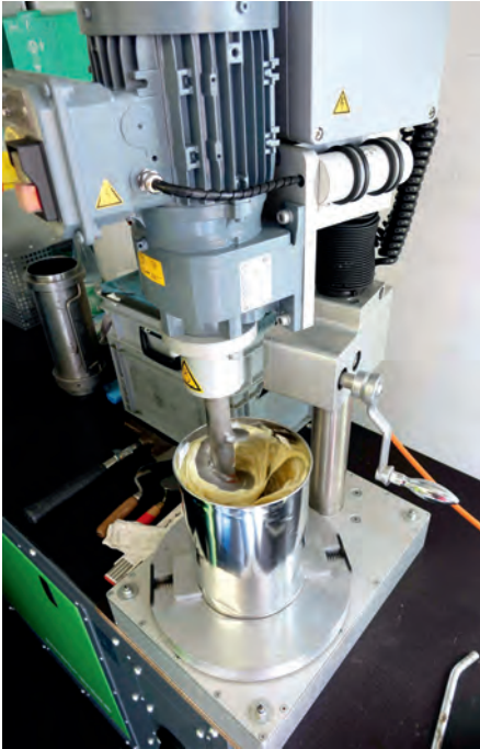
Die Anmischung des Harzes zur Füllung der Kartusche der PI.TRON-Spachtel- und Verpress-Einheit erfolgte im dafür vorgesehenen Anhänger
