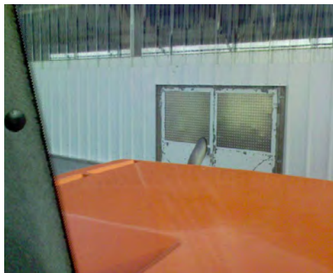
Abb. 3: Die beiden Bilder zeigen, was der Fahrer mit seinen Hilfsmitteln rückwärts sieht (links) und was tatsächlich hinter dem Bagger ist
