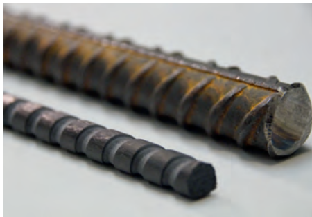
Abb. 3a, b: Matten- und stabförmige Carbonbewehrung im Vergleich zu Stahlbewehrung (rechts oben) (Fotos: Sandra Kranich)
