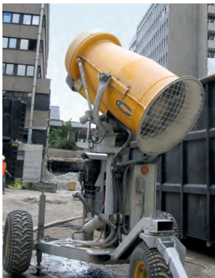
Abb. 2a und b: System zur Staubbindung – Beim Einsatz ist dafür zu sorgen, dass der Gefahrenbereich um dieses System gesperrt bzw. eindeutig gekennzeichnet ist
